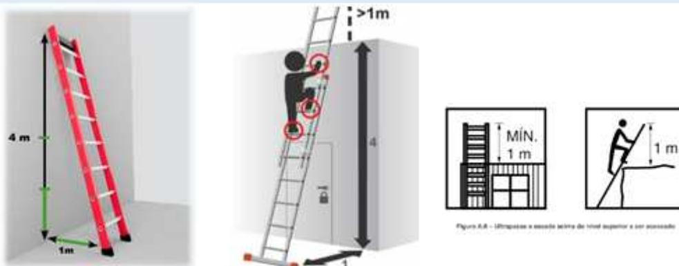
Figura AA - Ultrapassar a escada acima do nível superior e ser acessada
