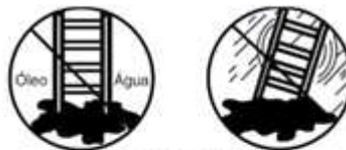
Figura A6 - Não utilizar em pisos contaminados
